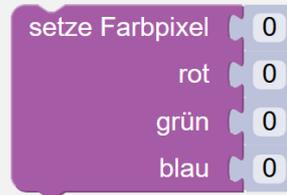
Mit dem Block «setze Farbpixel» sagst du einer bestimmten LED, in welcher Farbe sie leuchten soll. Die LED sind nummeriert von 0, 1, 2, 3 und so weiter. Die Farbe setzen sich aus den Anteilen rot, grün und blau zusammen. In deinem Programm verwendest du pro LED nur einen der Anteile. Die Farbanteile sind Zahlen im Bereich von 0 (kein Anteil = dunkel) bis zu 255 (maximaler Anteil = ganz hell).
