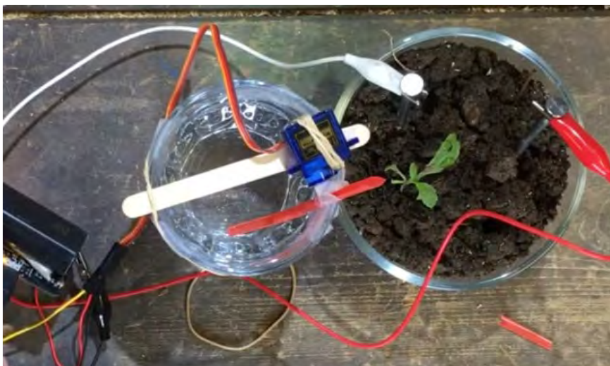
Abbildung 16 Einfaches Pflanztopf Bewässerungssystem mit Servomotor und Mini-Computer
