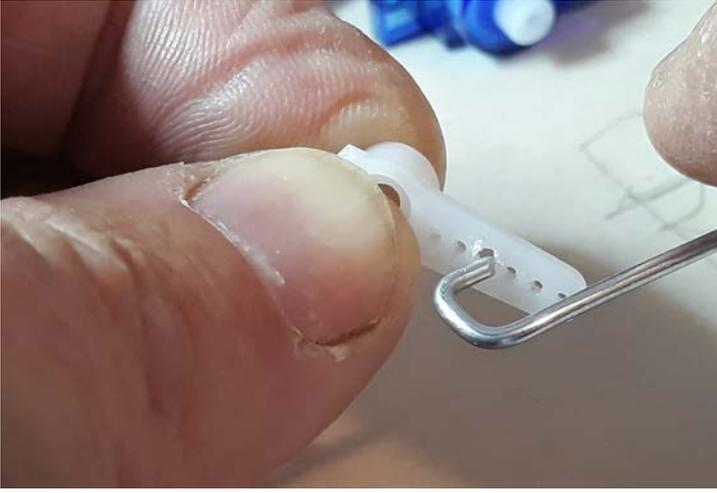
Draht wie in Bild dargestellt einsetzen
