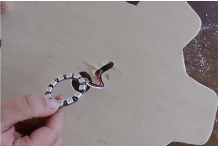
LED-Ring-Kabel von der Vorderseite der Uhr einfädeln (Vor- und Rückseite der Uhr berücksichtigen)
