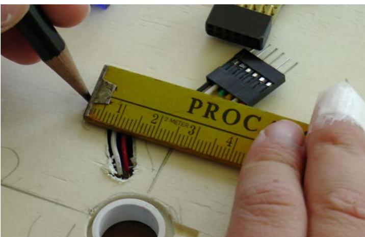
Servo-Position aufzeichnen, Abstände zu Zentrum der Platine und Ausrichtung beachten. Horizontal 24 mm, Vertikal 28 mm Abstand einzeichnen. Diese Position muss ziemlich genau sein (+/- 1mm)
