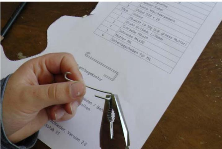
Draht gemäss Vorlage biegen. Achte darauf, dass der kleine Hacken 90 Grad nach oben abgewinkelt ist (siehe Bild)
