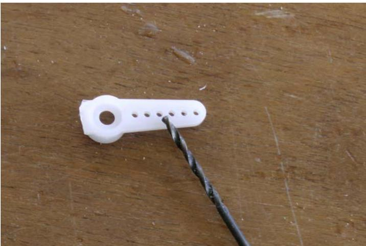
Das dritte Loch von hinten des Servoadapters mit 1.5mm Bohrer aufbohren, so dass Draht durch passt
