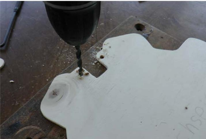
Löcher bohren, Unterlage verwenden (Achte auf Bohrer-
