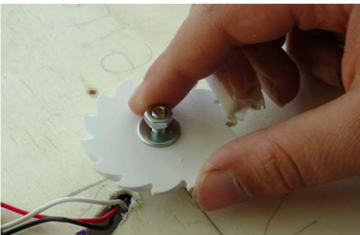
Zahnrad auf der Rückseite mit U-Schiebe und Mutter festschrauben; hier darf etwas stärker angezogen werden
